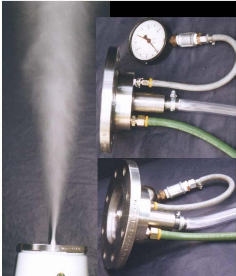
**Abbildung 10:** Strahldispergierung beim Hochdruckinjektor
